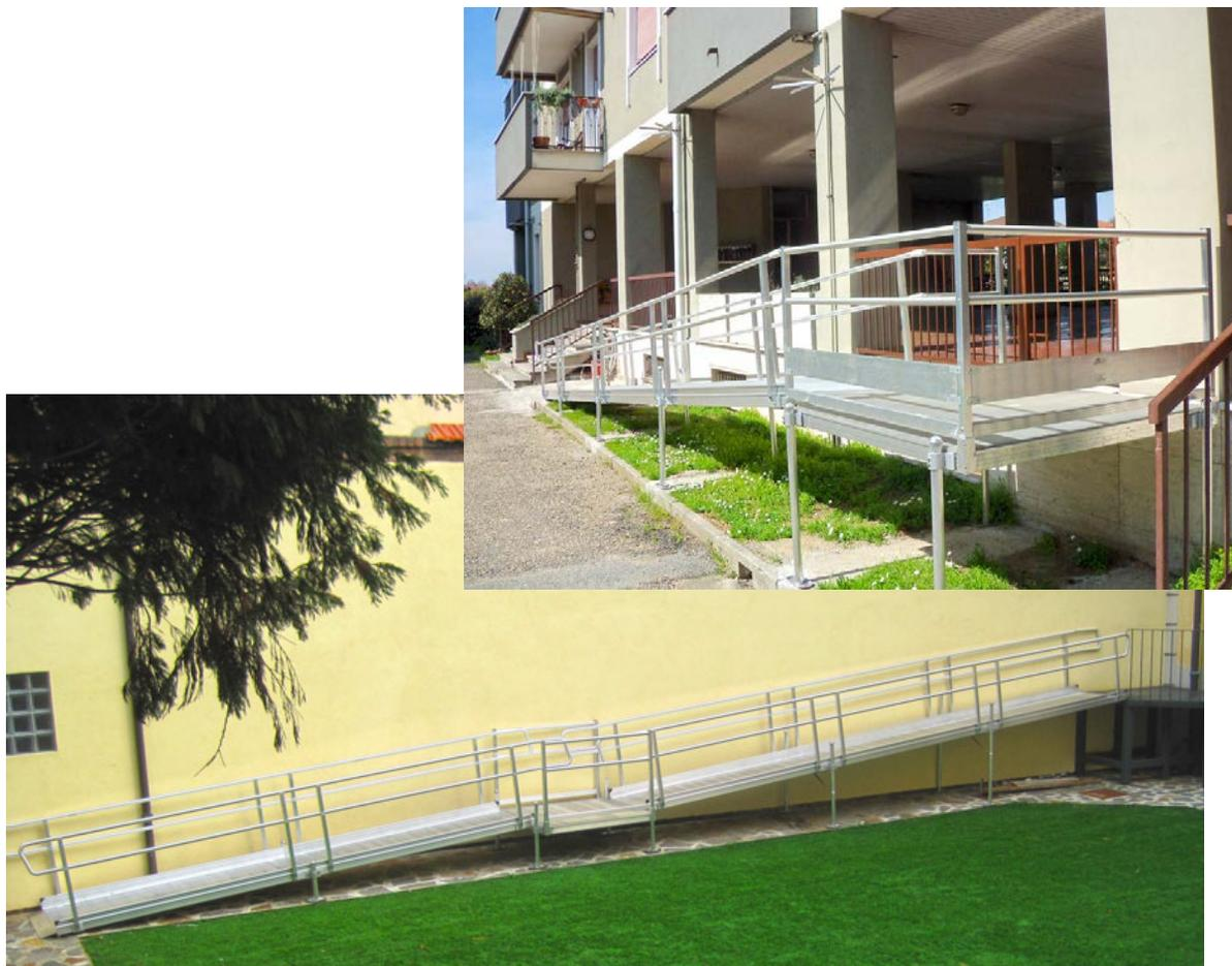
1. Sistema di rampe modulari in alluminio, componibili. Non richiedono opere murarie. Possono essere smontate e rimontate in caso di necessità. Parapetti e pavimentazione antisdrucciolo a norma DM 236 e certificate CE.
